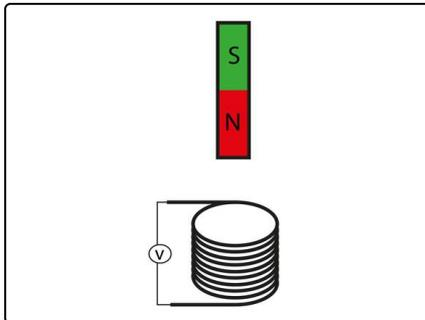
Elektromagnetische Induktion ist ein Vorgang, bei dem eine elektrische Spannung aus der relativen Änderung eines Magnetfeldes zu einer Spule oder Schlaufe beobachtet werden kann:
