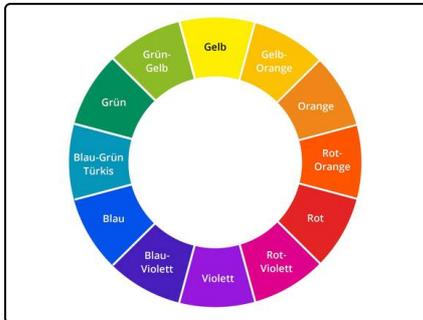
Wird eine Probe mit weißem Licht bestrahlt, so absorbiert diese einen Teil des Lichtes und der andere Teil wird reflektiert. Absorbiert die Substanz das grüne Licht, so wird die Komplementärfarbe Rot reflektiert. Das heißt, durch Vermischen zweier Komplementärfarben erhält man wieder weißes Licht. Komplementärfarben liegen sich auf dem Farbkreis nach Johannes Itten genau gegenüber.
